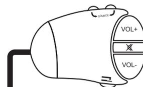
Desmontar a capa do volante para ter acesso ao chicote do comando de volante. Cortar o chicote e ligar os fios da interface cor com cor como mostrado no diagrama abaixo
